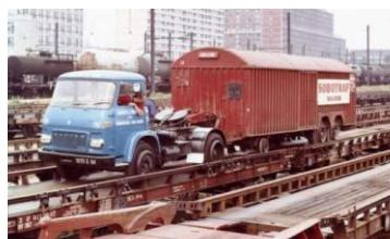
La norme mondiale adoptée pour les outils de manutention permet une prise supérieure des conteneurs par twist locks. Les caisses mobiles Rail – Route utilisent un outillage normalisé, de prise par pinces en partie basse. Ce dispositif coexiste sur les grues.
