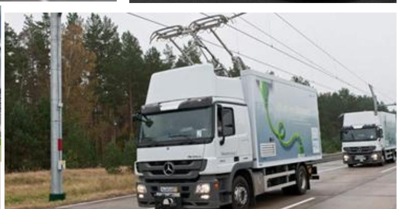
Siemens, inspiré de ses locomotives expérimente également une caténaire autoroutière et des pantographes pour réinventer un trolleybus marchandise.
